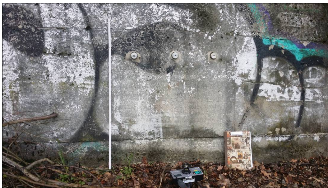
Obr. č. 3 - Odtrhové zkoušky P1 - P3 na dříku ZZ
